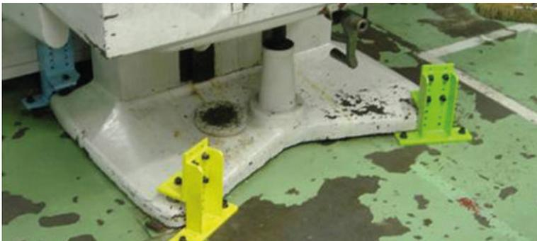
Am Boden verankerte Fertigungsmaschine
