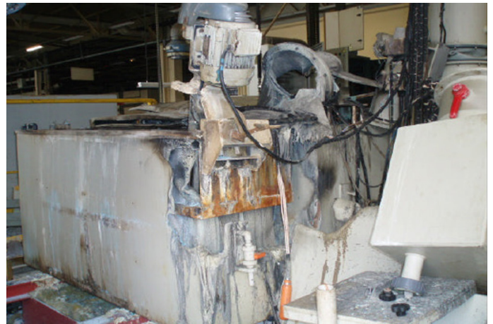
Domages incendie sur un réservoir en plastique
