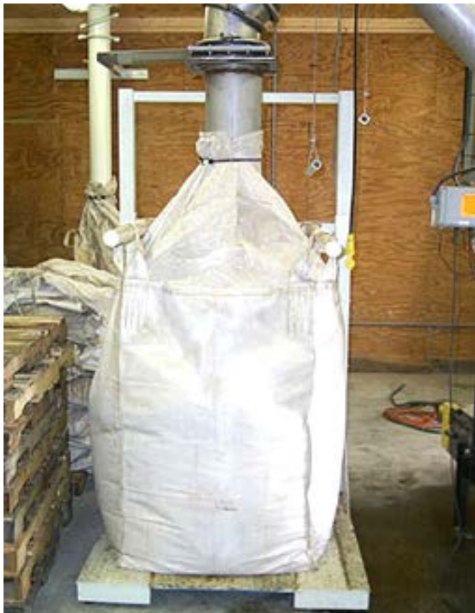
GRV souple en cours de remplissage (Source : inconnue)
