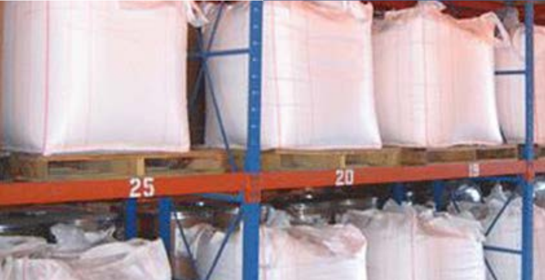
GRV souples stockés en racks. (Source : inconnue)
