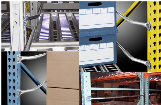
Foto: Barreras físicas usadas para mantener los espacios libres
