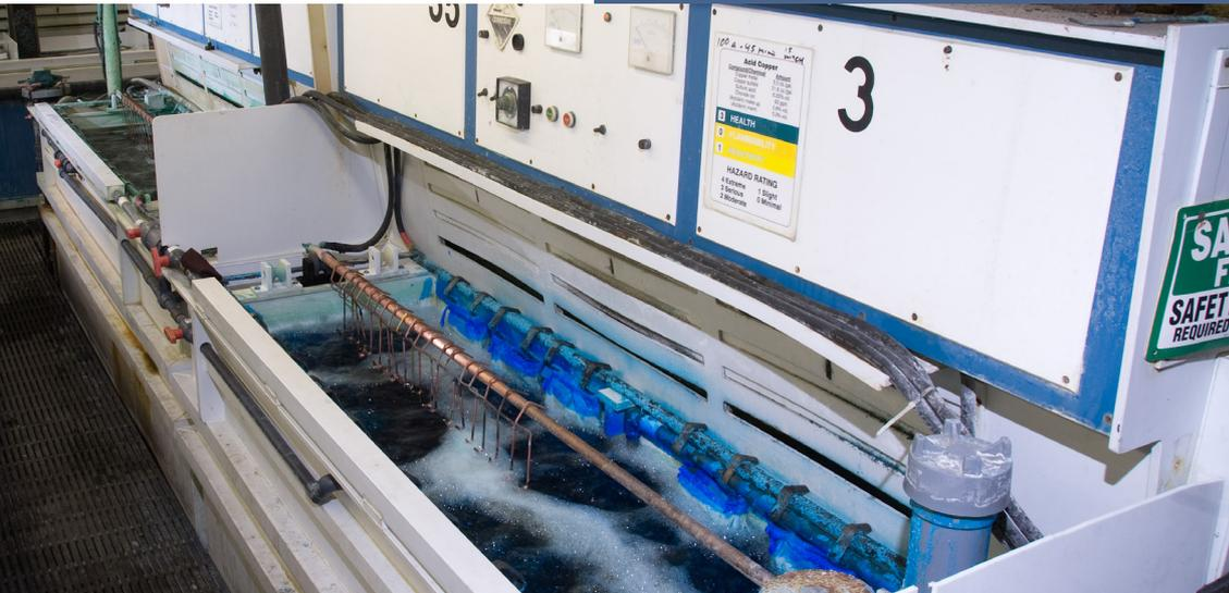
Bains de traitement chauffés en réservoirs plastiques
